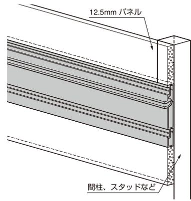
3. ねじ止め後、棚受レールの上にも板厚12.5mm
