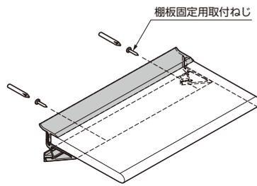
5. 図のように棚板と棚受取付用金具をねじで固定
