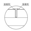
4-2 接着剤が硬化するまで固定します。 ※マスキングテープは接着材が硬化した後に取り外します。
